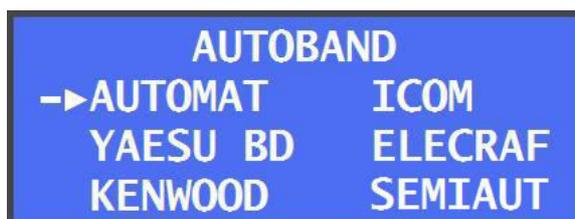
Selezione; AUTOMAT: Cambio Banda Automatico tramite il decoder interno, solo la connessione a **TX GND** è richiesta.
