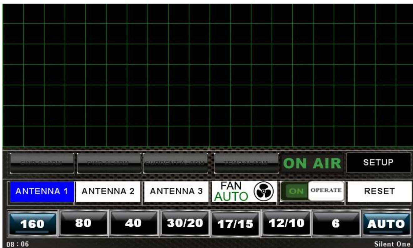
Cliccando sulla Barra di potenza (OUTPUT POWER), si abilita lo storico potenza con schermo a divisione (circa 200W per divisione) che ci indicherà lo storico della potenza in uscita, per tornare alla barra di potenza cliccare nuovamente sullo schermo in alto.
