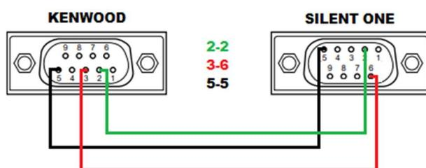
**7.4** Impostare la velocità di comunicazione seriale del transceiver a 9600 baud.
