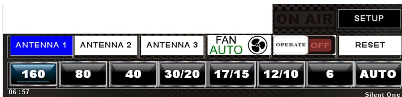
**ON AIR** ha 3 colorazioni ad indicare i vari modi del PTT, colore NERO **ON AIR** indica che il PTT è disabilitato (vedasi comando tasto Operate Off-On), Colore VERDE **ON AIR** indica che il PTT è abilitato (Operate ON), colore rosso **ON AIR** indica che siamo in Trasmissione.
