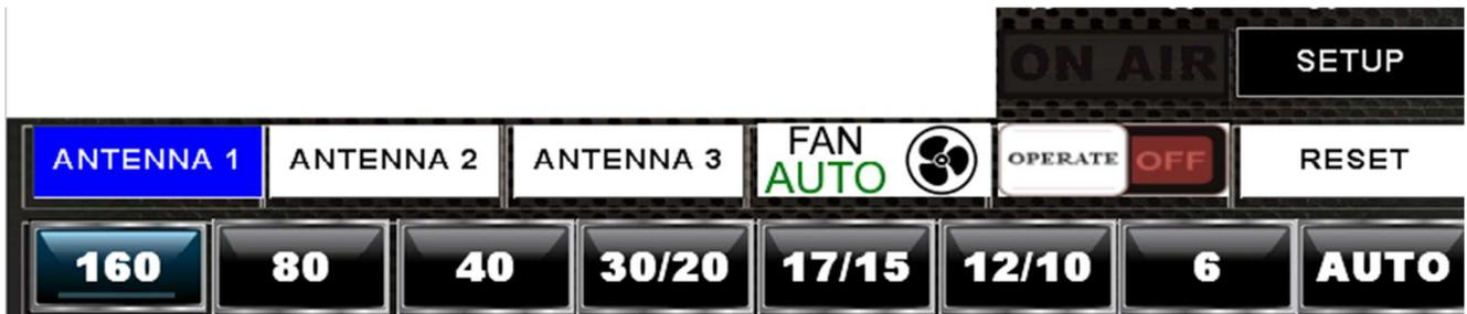
**ON AIR** ha 3 colorazioni ad indicare i vari modi del PTT, colore NERO **ON AIR** indica che il PTT è disabilitato (vedasi comando tasto Operate Off-On), Colore VERDE **ON AIR** indica che il PTT è abilitato (Operate ON), colore rosso **ON AIR** indica che siamo in Trasmissione.
