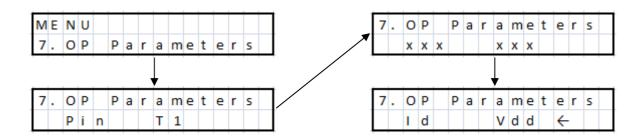
Tramite il pulsante 'Navigate' Selezionare il menu '7:TX Parameters' ora premere 'Enter' per entrare. Usare '+' per selezionare una delle 10 opzioni e premere 'Enter' per salvare l'impostazione e tornare al menu principale.
