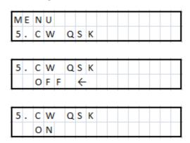
Per minimizzare i tempi di commutazione RTX ottimizzando la modalità 'Full Break In'. Specialmente se si utilizzano 25WPM o più è necessario attivare questa opzione. Tramite il pulsante 'Navigate' ② Selezionare il menu '5:CW QSK' ora premere 'Enter' ④ per accedere. Usare '+' ⑥ e '-' ⑤ per selezionare 'On' o 'Off' e premere 'Enter' ④ per salvare l'impostazione e tornare al menu principale. Quando tornerete in 'Operate' la visualizzazione sul display cambierà come segue:
