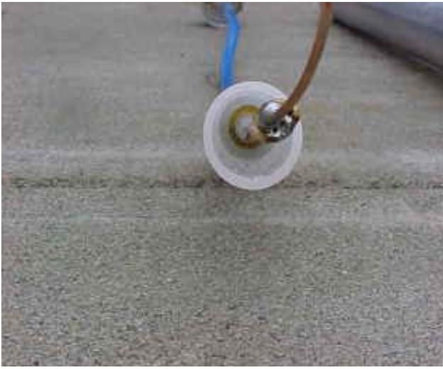
Auf diesem Foto können Sie in die Kondensator-Kopplungseinheit hineinschauen.
