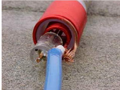
Auf diesem Foto können Sie vom Koaxialkabel-Mittelleiter bis zum äußeren Ende der Abstimmspule die ineinander liegenden Spulen und die ungelötete Verbindung besser sehen.
