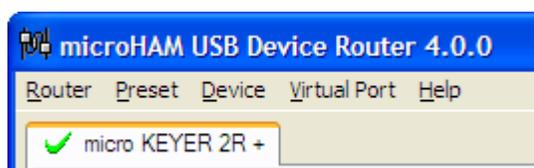
Quando il driver USB è stato installato correttamente ed il MK2R è acceso, il Router visualizzerà un Tab con una spunta **VERDE** prima del nome del dispositivo (micro KEYER 2R).
