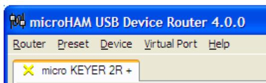
Quando il Router mostra una "X" **GIALLA** al posto della ✓ verde, significa che il driver USB è stato installato correttamente ma il MK2R non è acceso.
