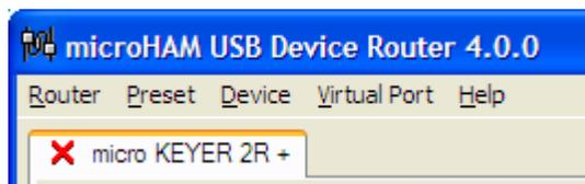
Quando il Router mostra una "X" **ROSSA** al posto della ✓ verde, significa che il dispositivo è scollegato ed il Router non vede la parte USB del MK2R. Questo capita quando il cavo USB è scollegato o il driver USB non è installato correttamente.
