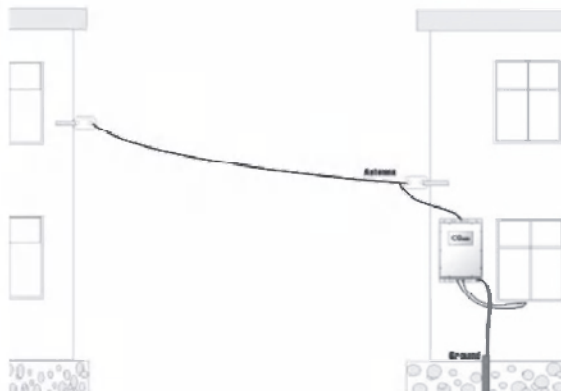
Rys. 2. Podłączenie anteny i uziemienia w CG-3000
