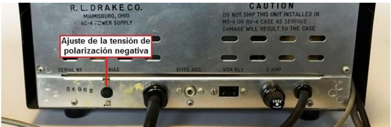
Figura 3-2 Control de ajuste de la tensión de polarización negativa
