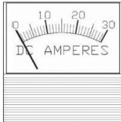
Fig. 15 Ammeter (Amp Meter)
