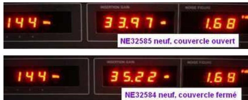
La substitution du NE32584 s'est révélée payante, mais également la suppression de la résistance  $33\Omega$  de Drain → Gain de 1.0dB sur la valeur de figure de bruit, mais on n'obtient toujours pas un Nf proche de 1.2dB
