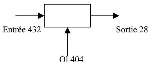
Nous voulons obtenir une fréquence de 432Mhz en TX à partir d'un signal 28Mhz.
