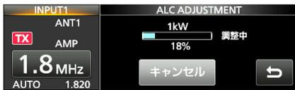
※「調整中」の表示になると、リニアアンプが強制的にON (ランプ: 白点灯)、アンテナチューナーはOFF (ランプ: 消灯)に切り替わります。
