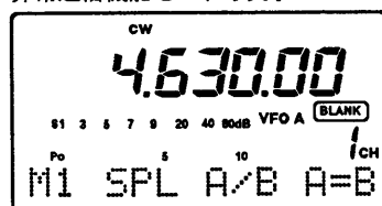
非常通信機能モードの表示
