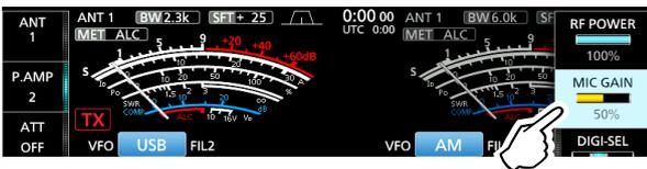
6. Toque otra vez el medidor para visualizar el medidor COMP.
