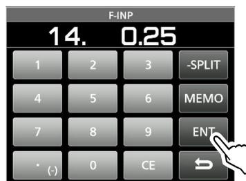
① Si toca [ENT] cuando los dígitos por debajo de 100 kHz no se hayan introducido, se introducirá "0" automáticamente en los dígitos que están en blanco.
