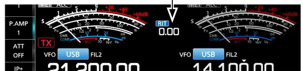
2. Gire [RIT/ATX] para ajustar la frecuencia RIT de modo que coincida con la frecuencia de la emisora transmisora.
