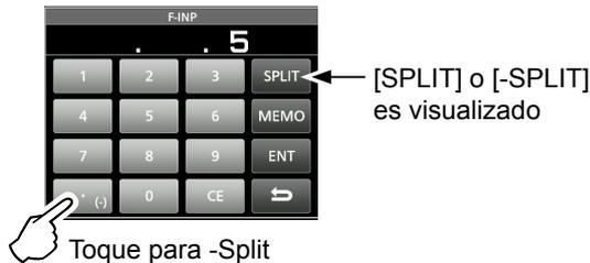
① Introduzca una compensación entre -9,999 MHz y +9,999 MHz (en pasos de 1 kHz).
