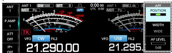
4. Toque para seleccionar el elemento y, a continuación, ajuste la posición del filtro de audio, el ancho de la banda de paso y el nivel de audio.
