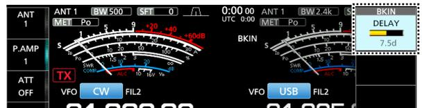
4. Gire **(MULTI)** para ajustar en el punto en el que el transceptor no regrese a la recepción mientras se está utilizando el manipulador.
