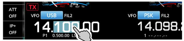
3. Toque el paso de sintonización. (Ejemplo: 0,1 k)
