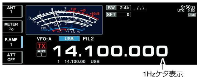
1Hzステップ(ファインチューニングステップ)で周波数を可変できます。
