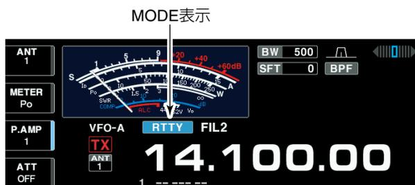
本製品の[USB]スロット(☞P2-7)にキーボードを接続するだけでRTTYを運用できます。
