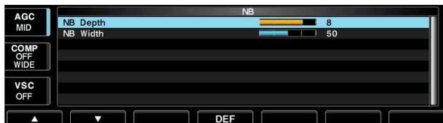
パルス性ノイズに応じて、ノイズブランカーのノイズ減衰レベル、ブランク時間が設定できます。
