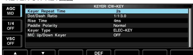
メモリーキーヤーのリピートタイム、DASHウエイトの可変、パドルの極性設定、キーヤータイプの変更などを設定します。
