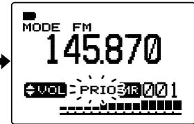
M-CH/バンクチャンネルで信号を受信すると、一時停止する
