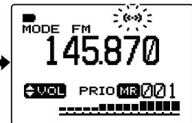
M-CH/バンクチャンネルで信号を受信すると、ベル音を鳴らして、ベルマーク“(●)”が点滅します。
