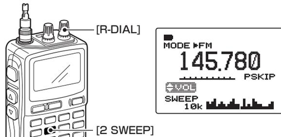
IC-R20のバンドスコープは、設定されたスイープステップの幅で信号を検出し、信号の有無や強弱を表示します。このため極端にスイープステップを大きく設定すると、実際には強い信号があっても表示されませんのでご注意ください。スイープステップは、20kHz以下での使用をおすすめします。
