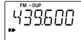
【SQL】を押すとオフセット分 変化した周波数で受信できる
