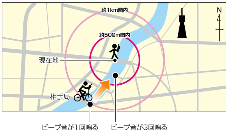
上図のエリア(○野線内)に対象となる局が入ると、GPSアラームが鳴り、GPSアラーム表示が点滅します。
