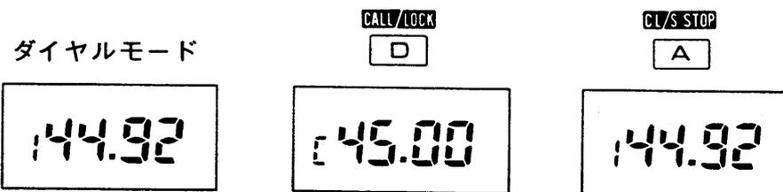
※コールチャンネルの解除は、クリアーキーを押すことにより、コールチャンネルを呼び出す前の周波数（ダイヤルモードまたはメモリーモード）に戻ります。
