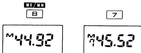
※以後、続けて他のメモリーチャンネルを呼び出す場合は、そのチャンネル番号を押すだけで呼び出せます。
