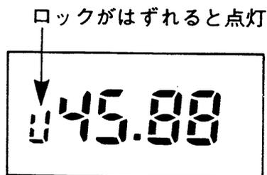
何かの原因でPLL回路のロックがはずれたとき(PLL回路が正常に動作をしていない状態)は、送信時ディスプレイのメモリー番号表示に“U”が点灯します。
