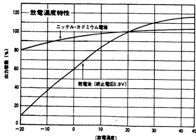
乾電池は、気温が低下するほど容量の減少が著しくなります。通常、乾電池の使用可能な温度の下限は、 $-10^{\circ}\text{C}$ とされていますから、寒冷地でご使用になる場合は電池部分を暖かく(充分保温する)してご使用になるか、ニッカド電池のご使用をおすすめします。
