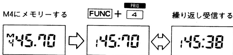
※M4を監視中に送信すると、ダイヤルモードまたはメモリーモードの周波数で一旦停止し、送信されます。受信に戻ると再び開始されます。
