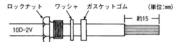
外被を除き、ロックナット、ワッシャ、ガスケットゴムを通し、外部編組をていねいに解く
