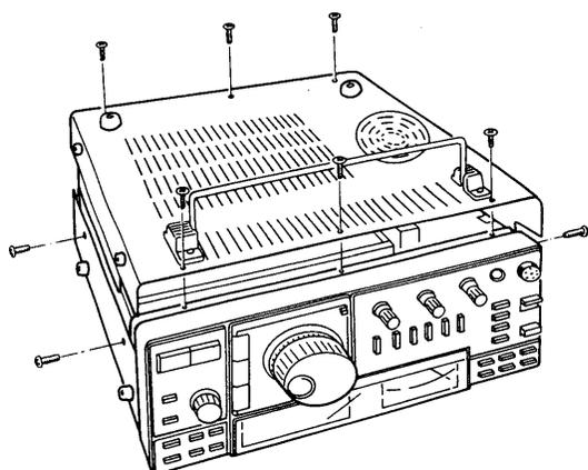
②本体後面のプレート(A)を外しておきます。このプレート(A)の位置にAC電源コネクター板を取付けます。
