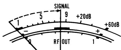
SSB,CWモードではツマミの位置によって、Sメーターの指針が振れます。
