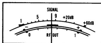
受信時の信号強度を表わすSメーター、FM受信時のセンターメーター、送信時の出力レベルを表わすRFメータとして動作します。
