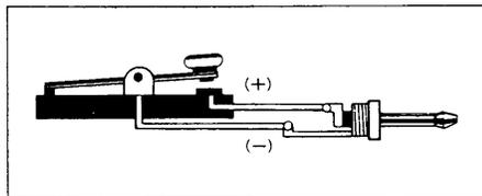
キーは、本体後面のKEYジャックに付属のプラグを使用し、図のように接続してください。
