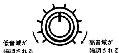
受信音の音質を調整するトーンコントロールのツマミです。
