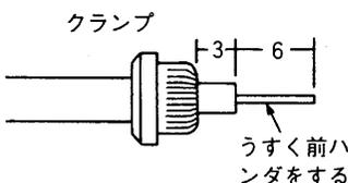
クランプを通して解いた編組を一本並べに広げ、余った編組を切落し、内部絶縁物、中心導線を寸法どおりに切断し、中心導線にうすく前ハンダをしてから中心コンタクトをハンダ付けする
