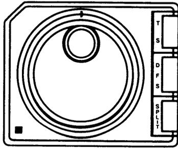
本機のメインダイヤルは、VFO/Mスイッチの切換え、MHzスイッチのON/OFFおよびDFSスイッチのON/OFFにより、運用周波数の設定またはメモリーチャンネルの呼び出しができます。さらに、リピーター運用時に必要なオフセット周波数およびトーン周波数の指定なども、メインダイヤルの操作で行ないます。
