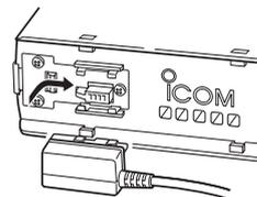
接続コネクタ部の溝をツメに合わせて差し込み、右側にスライドさせます。
