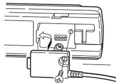
接続コネクタ部の突起部をコントローラーの溝に差し込み、ネジ止めします。
