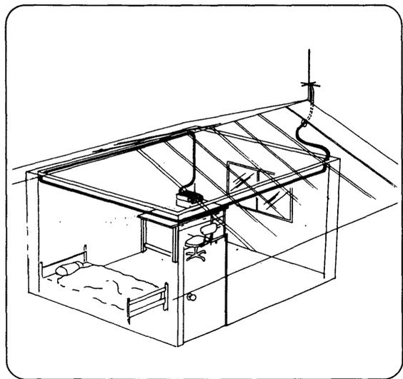
●同軸ケーブルには各種のものがありますができるだけ損失の少ないケーブルをできるだけ短くしてご使用ください。
