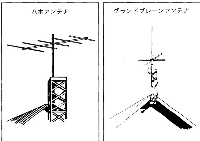
●本機のアンテナ整合インピーダンスは $50\Omega$ に設計されています。アンテナの給電点インピーダンスと同軸ケーブルの特性インピーダンスが $50\Omega$ のものをご利用ください。
