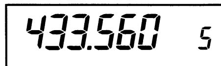
MEMORYモードのとき、[MW]スイッチを押しますと、そのメモリーチャンネルの内容がVFOに転送されます。
