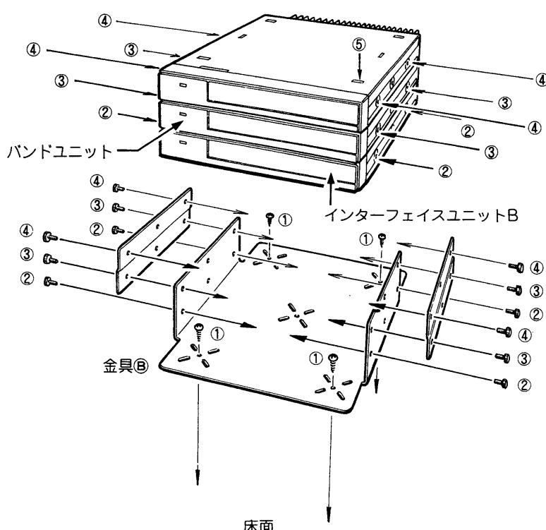
①付属の金具④を床面にタッピングビスまたはボルトナットで固定します。接着剤付きのスポンジも2枚付属していますので、平らな床面であれば金具をこれで固定できます。
