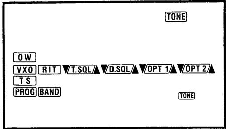
【SET】スイッチを押すことにより、下記のようにガイダンスが点滅します。
