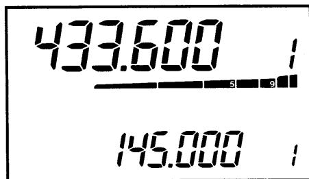
電子ボリューム方式のスケルチ設定用スイッチです。MAINバンド、SUBバンド別々に操作ができ、スケルチレベルはディスプレイのS/RFインジケーターで表示されます。
