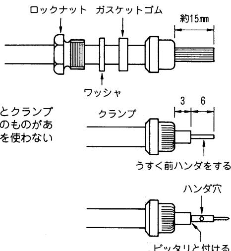
外被を除き、ロックナット、ワッシャ、ガスケットゴムを通し、外部編組をていねいに解く
