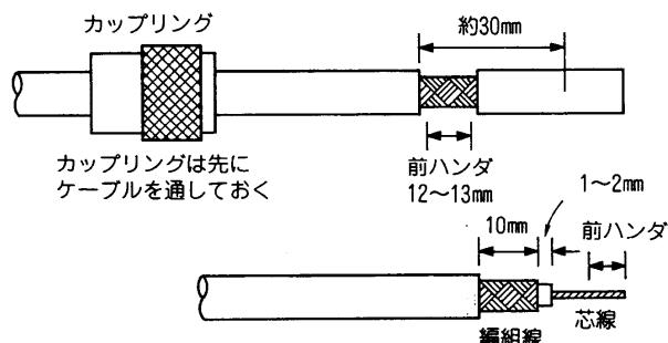
ナイフ、カッター等で外被を切り前ハンダがしやすいように外被を抜き取ってしまはずに、12~13mmの間を開けておく。
