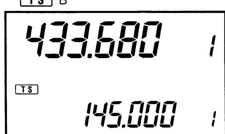
メインダイヤルの周波数ステップを2種類セットすることができます、このスイッチでどちらのステップを使うかを選択します。
