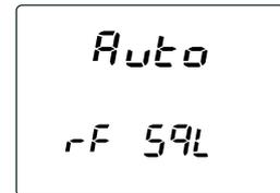
SSB/CWモード時はRFゲインツマミ、FMモード時は、SQLツマミとして動作する
