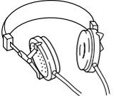
適合インピーダンスは8~16Ωです。ヘッドホンの出力は8Ω負荷で5mWとなるように設計されています。使用する市販品のヘッドホンによっては、音量が大きく異なりますのでご注意ください。
