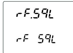
FMモード時はSQLツマミ、SSB/CWモード時はSQL/RFゲインツマミとして動作する
