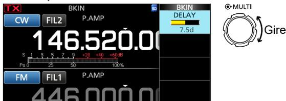
① Cuando utilice una paleta, pulse **(MULTI)** para visualizar el menú Multifunción y, a continuación, ajuste la VELOCIDAD DE TECLA mientras acciona la paleta.
