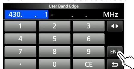
4. Introduzca la frecuencia del borde superior de la banda y, a continuación, toque [ENT]. (Ejemplo: 439,9)
