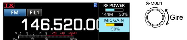
① El ajuste "50%" puede usarse en la mayoría de operaciones de voz, sin embargo, haga lo siguiente para asegurarse de que la ganancia del micrófono este correctamente ajustada.
