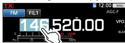
• Se abrirá la pantalla BAND STACKING REGISTER.
