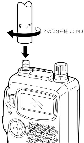
※外部アンテナを接続するときは、テレビなどのアンテナや、電灯線から離して設置してください。
