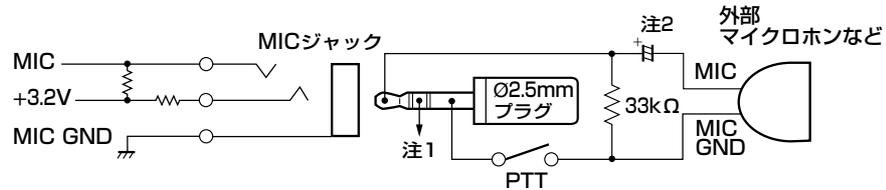
注1：本体内部の3.2Vラインから、390Ωの抵抗をとおして電圧を出力しています。
