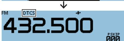
4. [PTT]を押しながら相手局を呼び出し、DTCSコードスケルチ機能を使用していないときと同様に交信する
