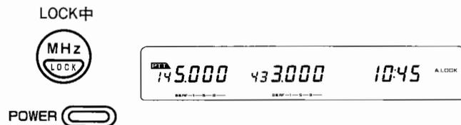
A.LOCKの解除にはもう一度電源を切り、MHz / LOCKキーを押しながら電源をいれます。
