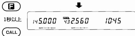
4. MHzモード等で希望する上限の周波数を設定します。(MHzモード 11ページ MHzキー参照)
