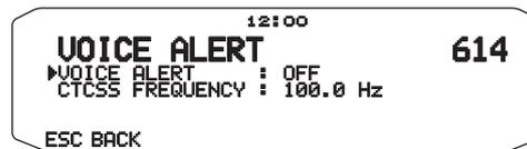
他局と音声通信をしようとする際、その局が近くにいるかどうかを聴感的に知る機能です。移動局がボイスアラート ON で移動しているとき、同様にボイスアラート ON で運用している局はトーン (CTCSS) 一致によりこの移動局のビーコン音を聞くことができるので、相手局が近くにいる、直接交信できることがわかります。
