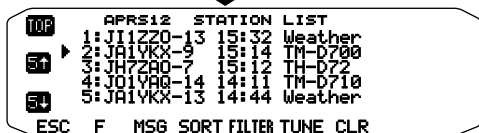
JI1ZZO-13 を受信後のステーションリスト画面 (カーソルは常に JA1YKX-9 に追従)
