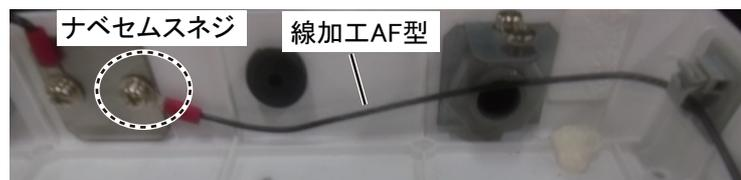
18. 手順 18 で取り外したナベセムスネジ (M4×15) を使って、支給の線加工 AF 型と手順 18 で取り外した線加工 AF 型を共締めにします (締め付けトルク :  $1.47\text{N}\cdot\text{m}$ )。
