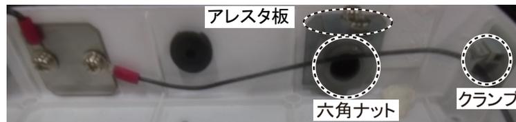
17. アース板右側のナベセムスネジ (M4×15) と、線加工 AF 型を取り外します。
