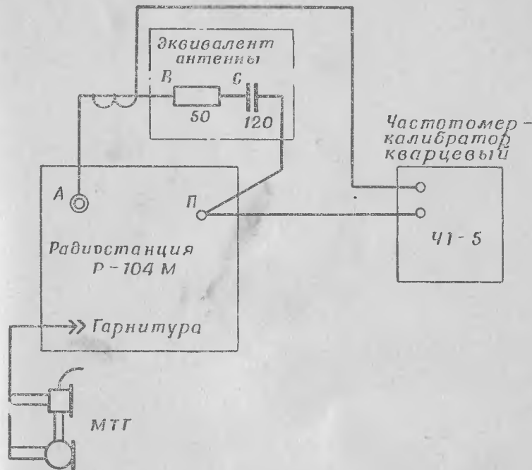
Рис. 4. Схема измерения погрешности градуировки приемопередатчика
