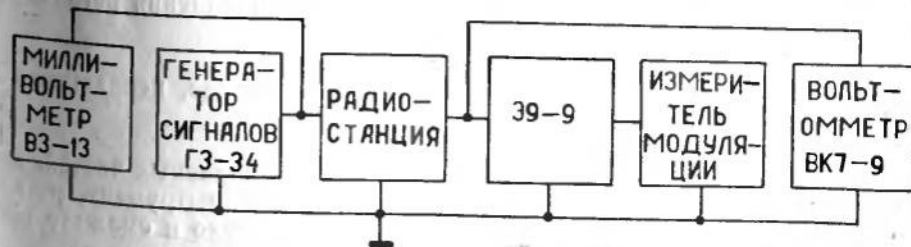
Рис. 21. Структурная схема измерения чувствительности модуляционного входа передатчика.
