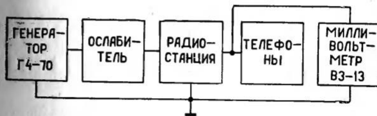
Рис. 17. Структурная схема измерения чувствительности приемника в режиме АТ.
