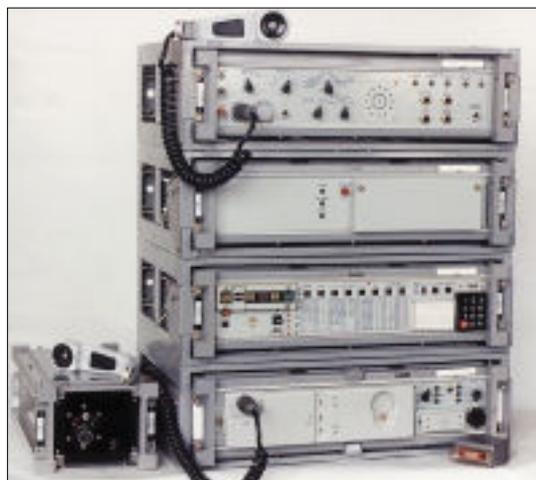
Предназначена для шифрования с гарантированной стойкостью речевой или цифровой информации и передачи ее другому абоненту по телефонным линиям связи и по радиоканалам с использованием КВ или УКВ радиостанций.
