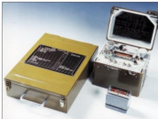
Предназначено для ввода и хранения ключевой информации, передаваемой для записи в аппаратуру E-24 и E-24D. Портативное устройство, обладающее способностью транслировать хранящуюся в нем ключевую информацию в одно или несколько засекречивающих устройств.
