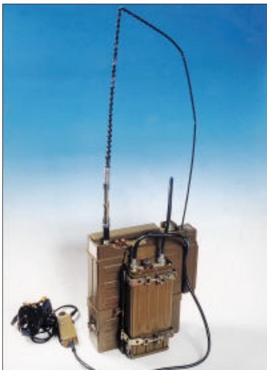
Предназначена для засекречивания информации при симплексной работе по радиоканалам М/ДМ диапазона, а также по проводным каналам с использованием специального устройства УСК-1. Применяется в тактическом звене - взвод, рота, батальон.
