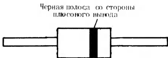
РИС. 36. РАСПОЛОЖЕНИЕ ВЫВОДОВ ДИОДА 2Д522Б, СТАБИЛИТРОНА 2С133А
