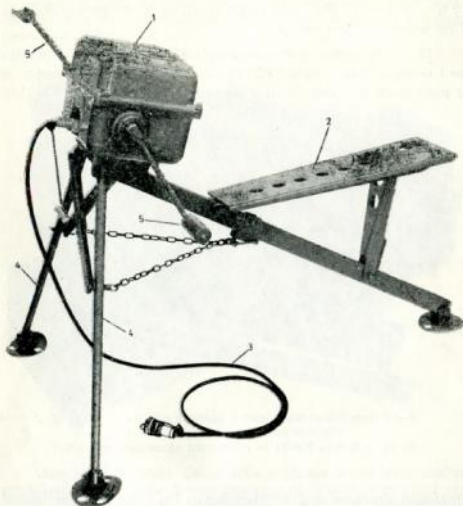
Sl. 11 — Ručni generator GR-2A (postavljen za rad): 1 — generator GR-1; 2 — nožica NO-1 sa sedištem; 3 — kabl KE-37; 4 — nožica NO-2; 5 — ručica RC-1.
