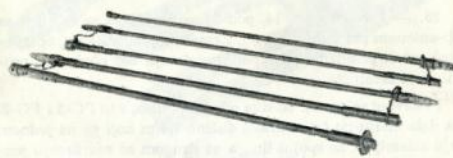
Sl. 15 — Štap-antena AT-14A
