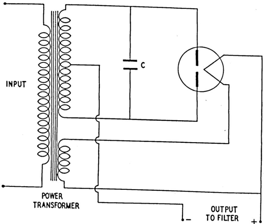
FIGURE 20. Full-wave rectifier.
