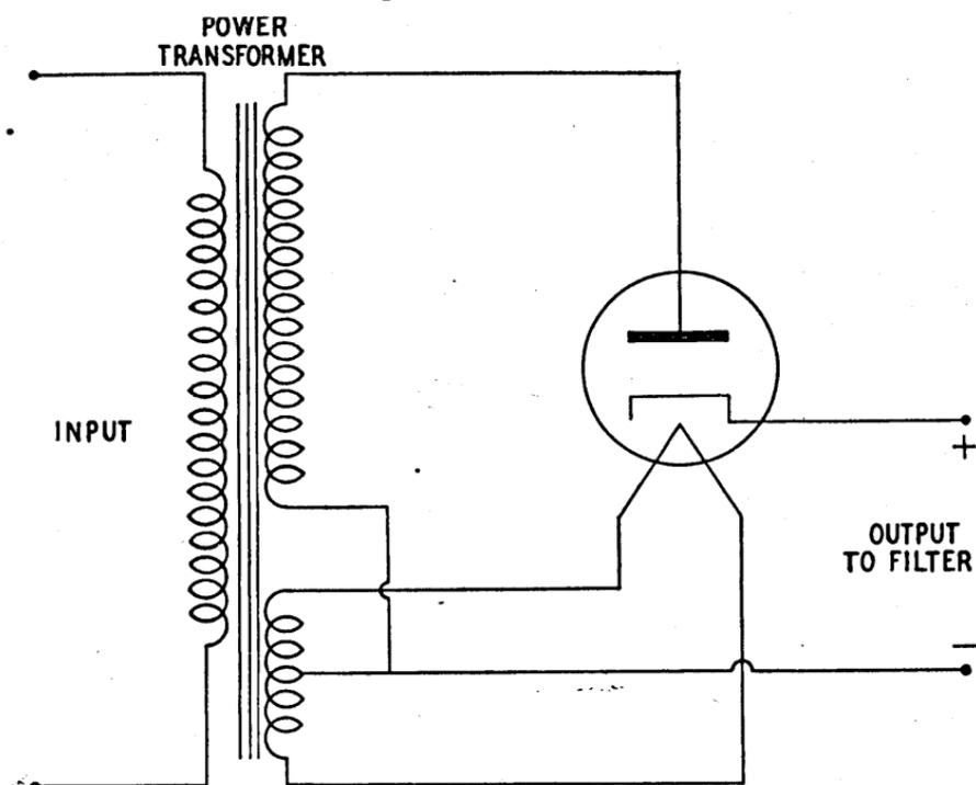
FIGURE 19. Half-wave rectifier.
