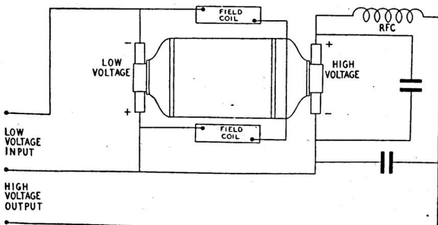
FIGURE 17. Dynamotor circuit.
