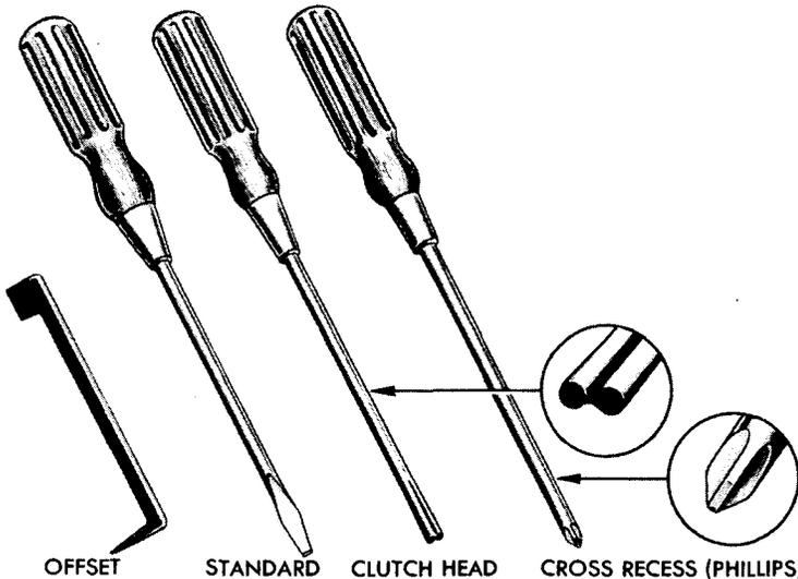
OFFSET      STANDARD      CLUTCH HEAD      CROSS RECESS (PHILLIPS)
