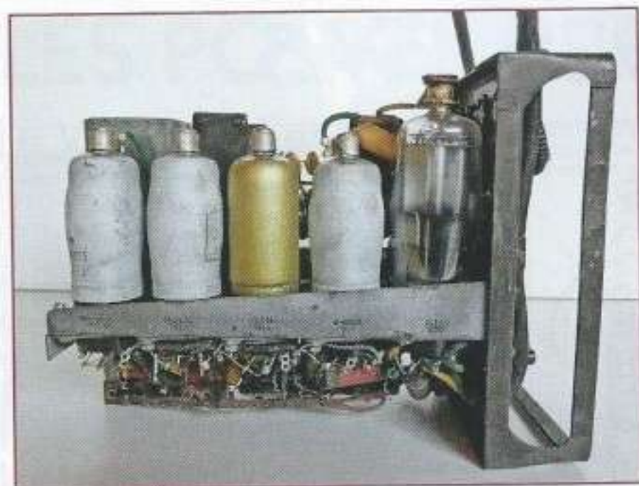
Ci-dessus. Détail des composants de l'appareil WS No 38 Mk 2*
