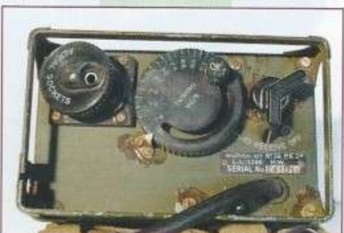
Vue de face supérieure (exploitation) du poste WS No 38 Mk 2* illustré ci-dessous.
