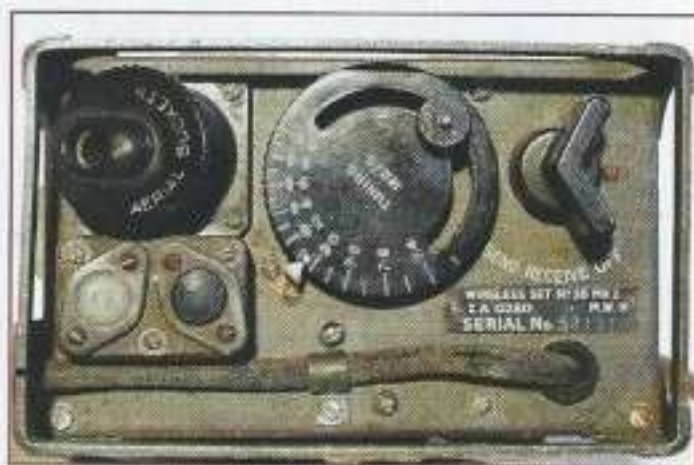
Face supérieure d'un poste WS No 38 Mk 2. On voit le bouton test des lampes, à gauche, avec son témoin lumineux.
