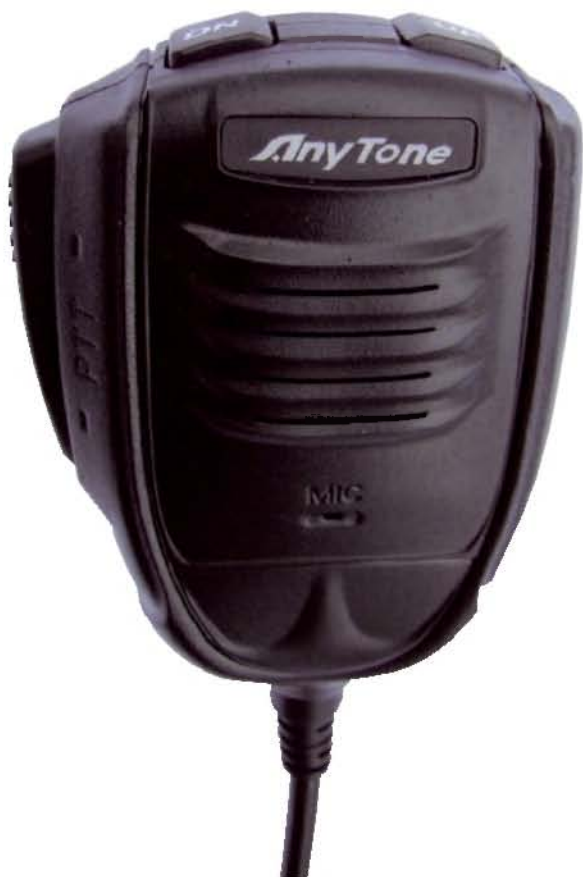
Na mikrofonie jest przelącznik kanałów dół/góra oraz przycisk nadawania PTT
