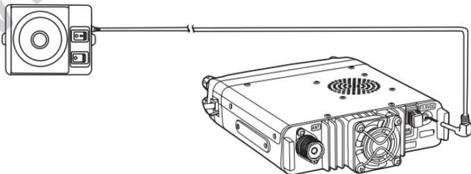
**Nota:** el altavoz externo adopta el doble puerto BTL, por favor, valore el método de conexión. El altavoz no puede conectarse con la toma de tierra, si no el altavoz podría averiarse. El método de conexión mostrado en la siguiente imagen es erróneo.
