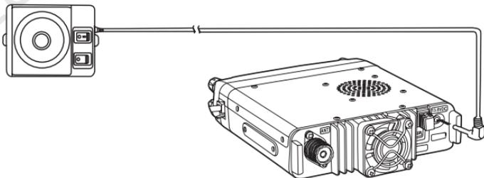
**Remarque:** le haut-parleur externe doit être branché à la connexion BTL à double port. Veuillez évaluer la méthode de connexion. Le haut-parleur doit être sans terre; au contraire, il risque d'être endommagé. La connexion représentée sur la figure à suivre n'est pas correcte.
