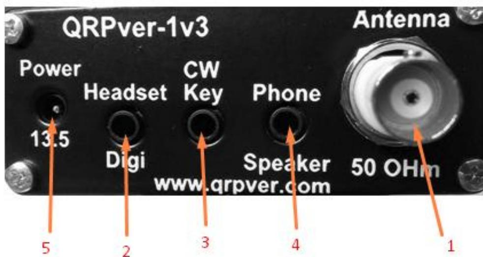
1. Разъем BNC типа для подключения антенны (50 Ом)
