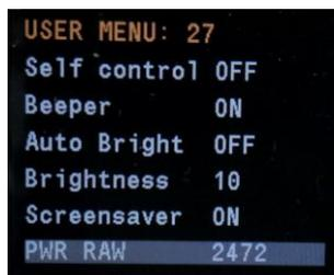
27. **PWR RAW**: Значение АЦП измерителя мощности передатчика. (Инженерный пункт меню).
