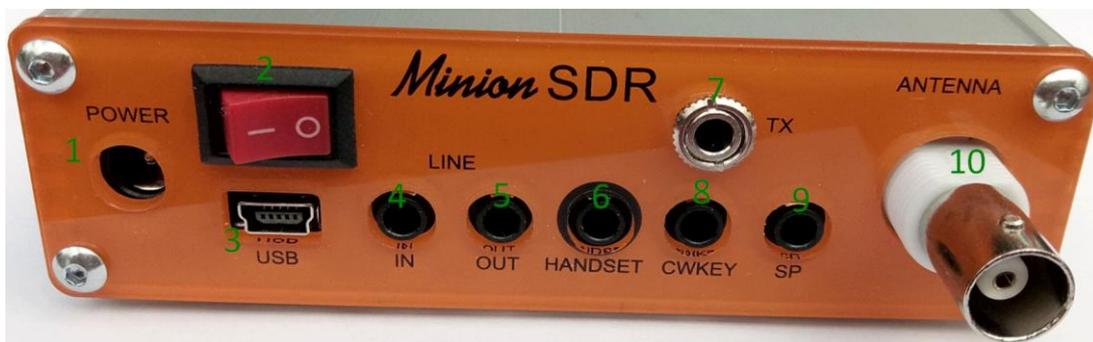
1. Гнездо для подключения к источнику питания (Power Plug 5 mm.).
