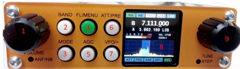
1. Регулятор громкости. Нажатие на ручку включит Автоматический режекторный фильтр для вырезания мешающего тонального сигнала при приеме станций. В режиме передачи регулируется громкость самоконтроля.
