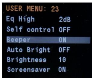
22. **Self control**: Включение “SSB” самоконтроля.
