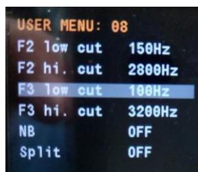
07. **F2 hi. Cut** : Вторая преднастройка фильтра, срез сверху.
