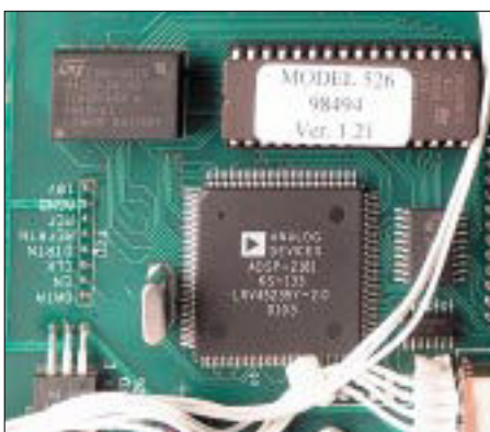
Das Gehirn des 526: EPROM mit Software Version 1.21, DSP-Chip und Stützbatterie Fotos: Ten-Tec (1), FA (3)
