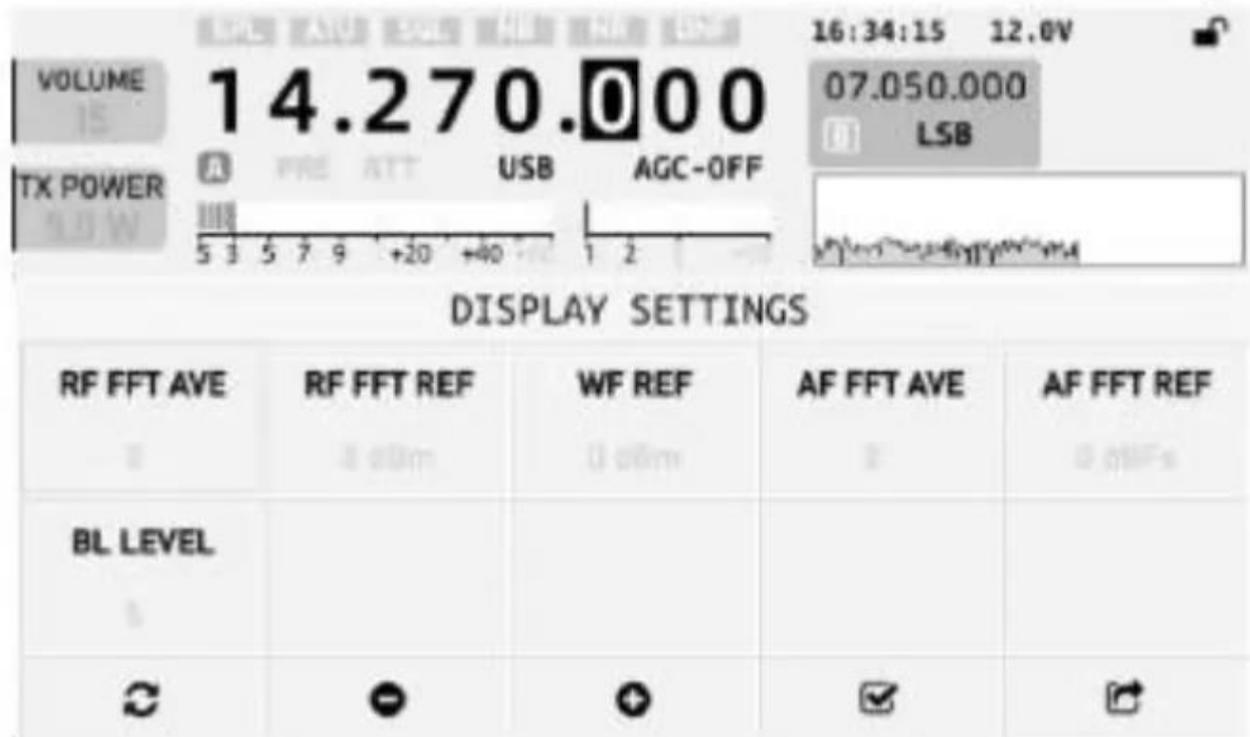
**RF FFT AVE:** impostazioni di una media visualizzata dello spettro delle radiofrequenze
