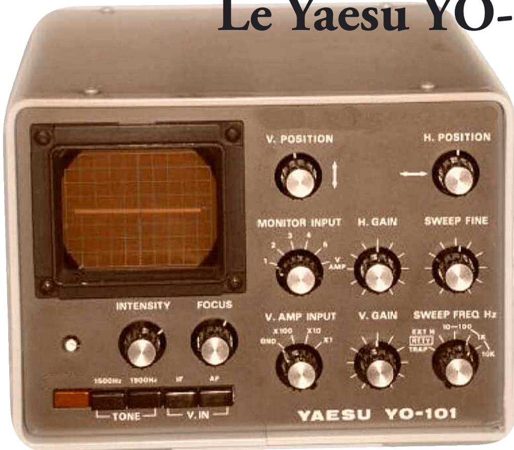
*Dans la plus pure tradition des transceivers de ces années là, Yaesu était le leader incontesté de l'innovation technologique. Cet YO-101 permettait de vérifier la qualité des signaux propagés par les antennes. Il s'agit d'un moyen simple d'apprécier la qualité des émissions. Il propose en plus des fonctions d'oscilloscope la possibilité d'inspecter le spectre radio autour de la fréquence centrale.*
