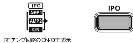
RF アンプ回路の ON/OFF 表示
