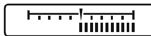
受信周波数と送信周波数のオフセット量がプラスの場合
