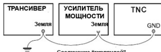
НЕПРАВИЛЬНОЕ ПОДКЛЮЧЕНИЕ ЗАЗЕМЛЕНИЯ Соединение "гирляндой"
