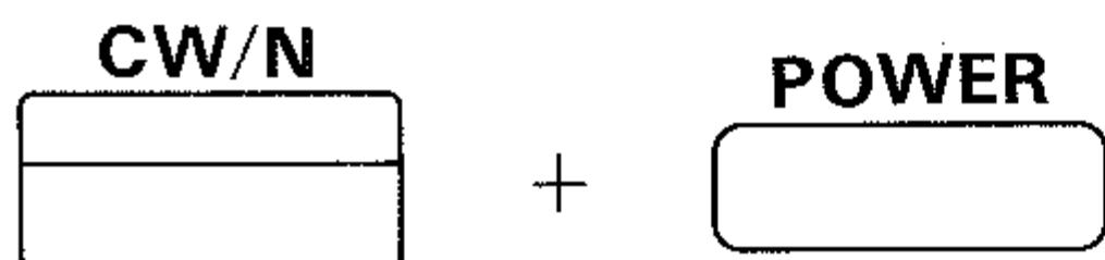
このように動作させるためには電源をいちど OFF にして、CW キーを押しながらふたたび電源を ON してください。これにより 3.5MHz 帯と 7MHz 帯では BFO 周波数の位置が、LSB 受信時と同じ位置になります。
