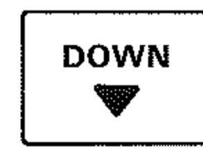
DOWN キーを押します。DOWN キーは 1 回押すたびに周波数は 1 MHz ずつ低くなりますから、たとえば 1.030.80MHz まで来たら FAST キーを OFF にします。
